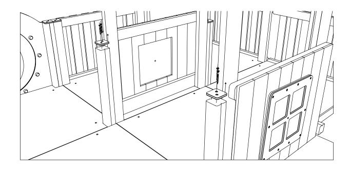
**14** ATTACH W0106 SPECIFIC GUARD RAIL. USING M8X80 [X8]
