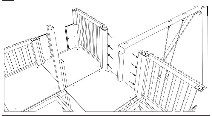
10 INSTALL U-SHAPED GUARD RAIL TO W0106-DD USING M8X80 SCREWS [X8]
