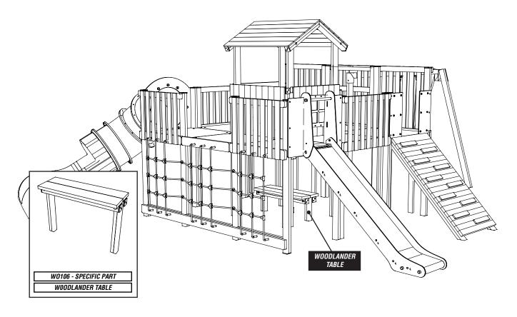
SCREW WO-TABLE SEATS TO CENTRAL UPRIGHT TIMBERS ON EACH SIDE USING M8X180 SCREWS [X8]. ENSURE FLOOR TO TOP OF SEAT HEIGHT IS 350MM
