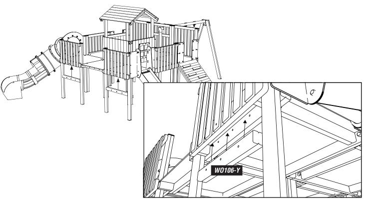
19 INSTALL NET TIMBER ASSEMBLY TO UPRIGHTS 1178MM FROM BASE OF GUARD RAIL - USING M8X80 [X8]
