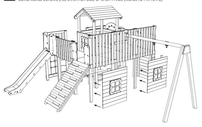
FIX W0106 SPECIFIC - LARGE TIMBER PANEL TO MIDDLE UPRIGHTS FROM THE INSIDE USING M8X80 SCREWS [X4] ON EITHER SIDE OF THE PANEL (M8X80 X8 IN TOTAL)
