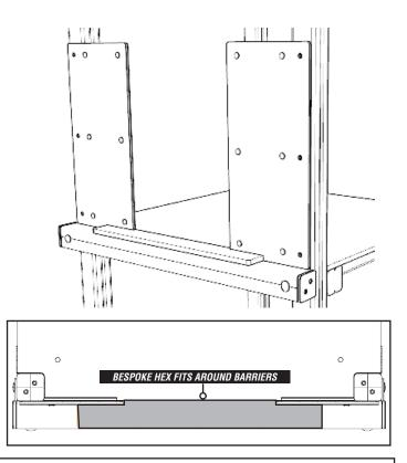
**NOTES:**\*BARRIER REINFORCEMENT PANEL (ON REVERSE) SHOULD <u>BUTT UP TO UPRIGHT</u> TIMBER
