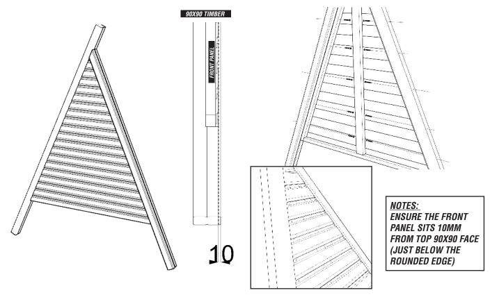
POSITION/ PROP TIMBERS TOGETHER AS SHOWN TO ATTACH SIDE PANELS
